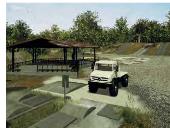
Digitaler Zwilling des autonomen Unimogs bei der virtuellen Erprobung und Vorabtests auf dem simulierten Daimler Testgelände Kiesgrube Otigheim. Simulierte Tests erlauben ein frühes Testen und die zeitnahe Identifikation von Konzeptschwächen und Fehlern.
