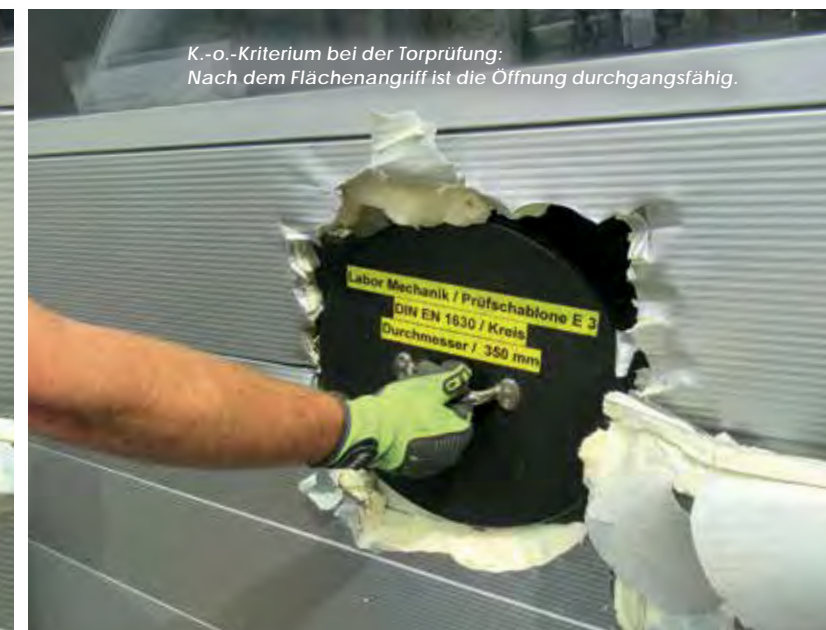
Schadensbild an Sektionaltor nach manuellem Flächenangriff
