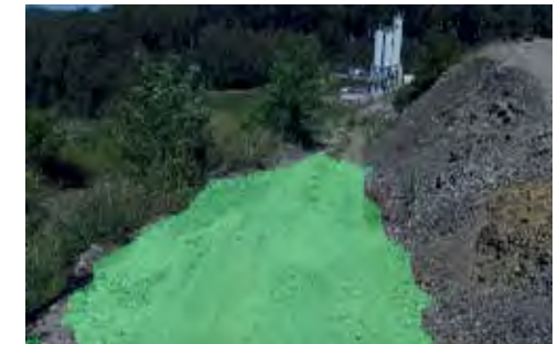
Kamerasicht auf den Geländeabschnitt vor dem Fahrzeug. Der Unimog verfügt über viele Kamerasysteme, die situativ ausgewertet werden, um KI-basiert Objekte wie Fahrzeuge oder Personen zu erkennen und Fahrwege zu identifizieren.
