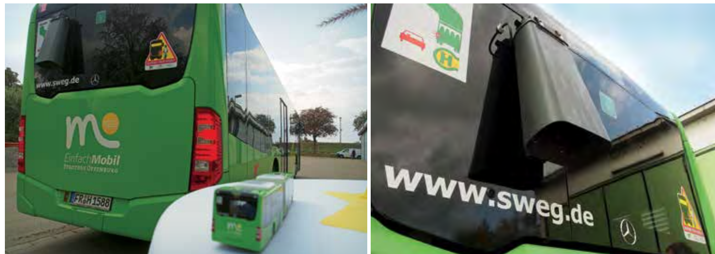
Der Linienbus mit mobilem Straßenwittersensor „Marwis“ sammelt bei seinen Fahrten durch Offenburg und Umgebung Daten über den Straßenzustand. Der fast unscheinbare Wittersensor ist an einer Aluminiumplatte am Heck des Busses angebracht.
