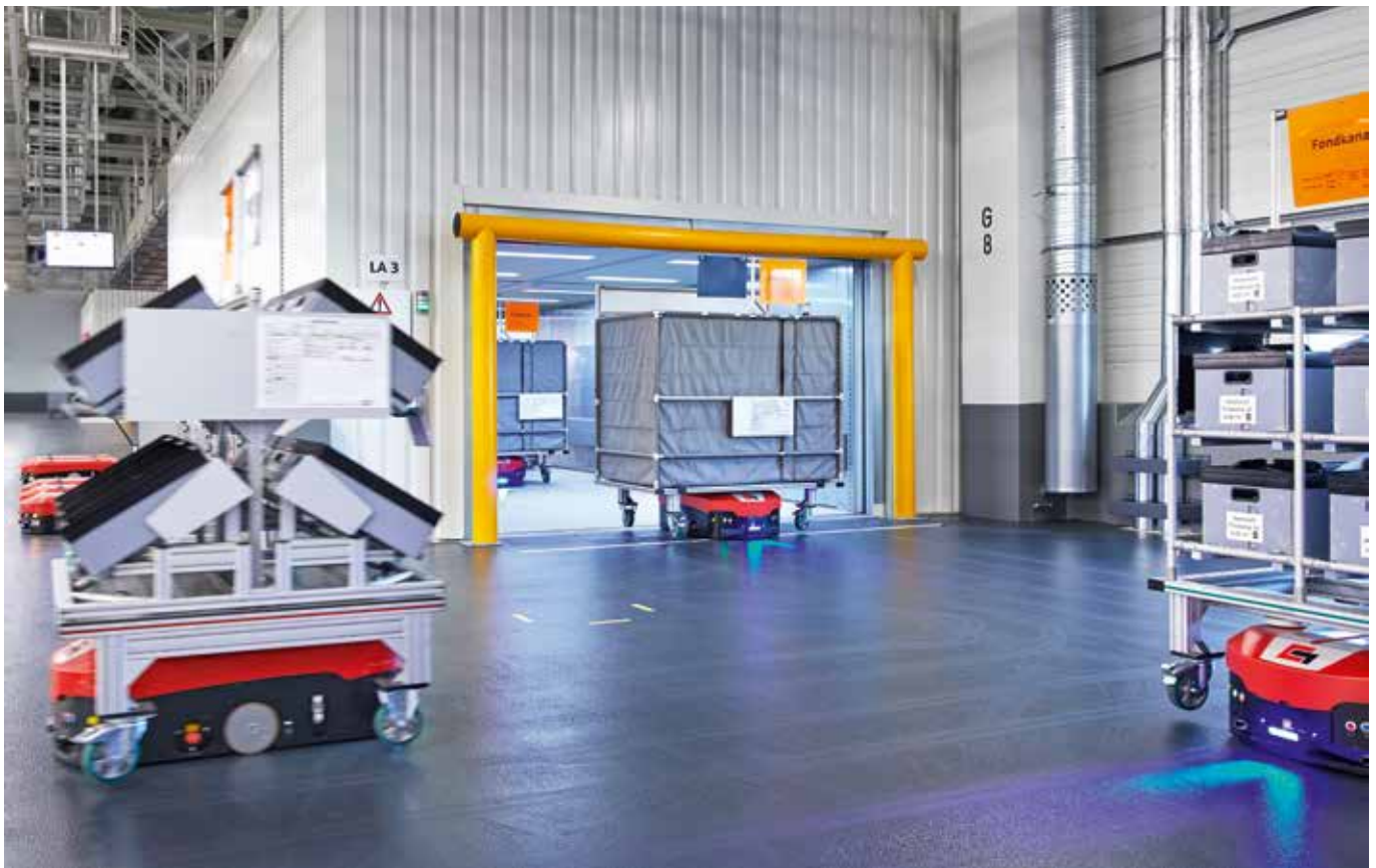
In Neckarsulm werden die fahrerlosen Transportfahrzeuge auf drei Ebenen eingesetzt. Sie nutzen dafür über den Flottenmanager die Aufzüge.
