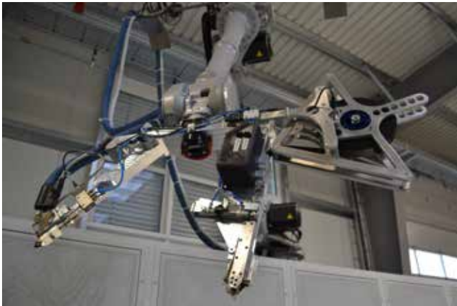
Die CNC-R-gesteuerte Klebeklettmontageanlage bestückt unterschiedliche Fahrzeuginterieurteile vollautomatisch mit Klettband.
