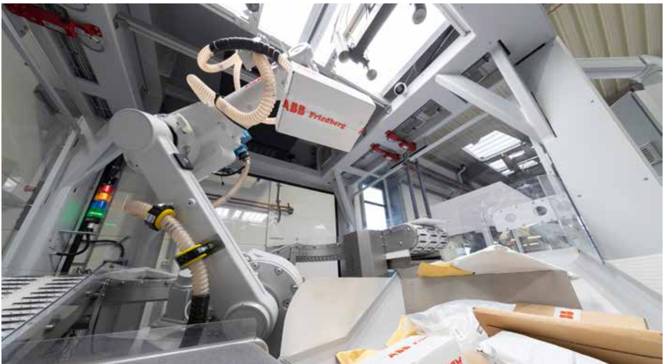
Gemeinsam mit dem Startup Covariant hat ABB eine KI-basierende Greifanwendung zur Auftragsabwicklung in Logistikzentren entwickelt.
