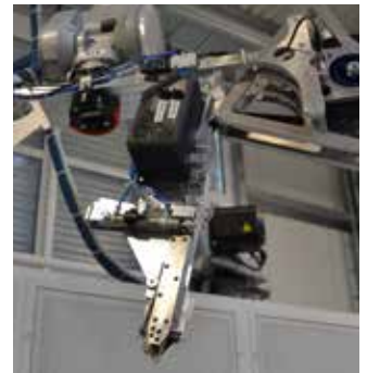
Die Klebeklettmontage wird vollautomatisch ausgeführt.
